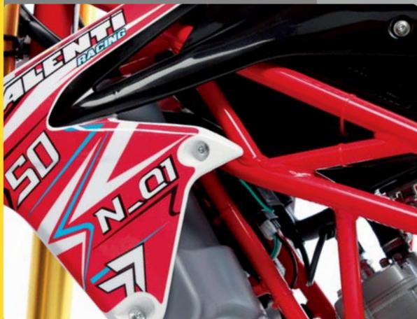
TELAIO TRALICCIO IN ACCIAIO
